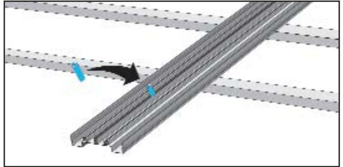
Alle, außer den am Rand zu verwendenden Profilen, werden mit je 2 Plastikhülsen versehen. Dazu die Plastikhülse an der entsprechenden Stelle mit der Hand fest in den Mittelkanal des Profils drücken. Achten Sie möglichst auf eine einheitliche Positionierung.
