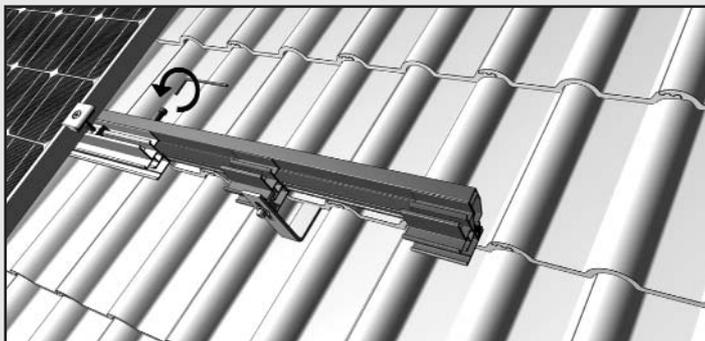
Richten Sie das im Schritt 19 bereits lose montierte Teleskop-Endstück genau so aus, dass ausreichend Platz für das letzte Modul, den letzten Modulhalter und den Endhalter bleibt (Berechnung: Modulbreite/-länge in Millimetern + 43 mm). Fixieren Sie jetzt das Teleskop-Endstück mit dem Innensechskantschlüssel (linke Seite).
