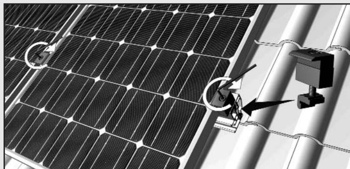
Legen Sie das letzte Modul der Reihe auf die Schienen (achten Sie bei der ersten Modulreihe darauf, dass sich die Abrutschsicherung im Schienenkanal befindet) und fixieren Sie den letzten Modulhalter und den Modul-Endhalter mit dem Innensechskantschlüssel (Anzugsmoment 8 Nm).
