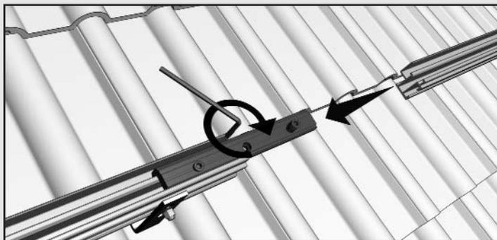
Um mehrere Profile der Grundschiene 3/37 aneinander zu reihen, Quickstone-Verbinder seitlich zur Hälfte in die bereits montierte Profilschiene einschieben. Die erste Innensechskantschraube M8 festziehen. Die nächste Profilschiene seitlich auf den Verbinder schieben.
