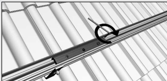
Die zweite Innensechskantschraube M8 mit dem Innensechskantschlüssel festziehen. Die Verbindung ist fertig. Es empfiehlt sich eine Dehnungsfuge an den Schienenstößen. Lassen Sie hierzu einen ca. fingerbreiten Spalt zwischen dem Schienenstoß und fixieren dann die zweite Innensechskantschraube M8.
