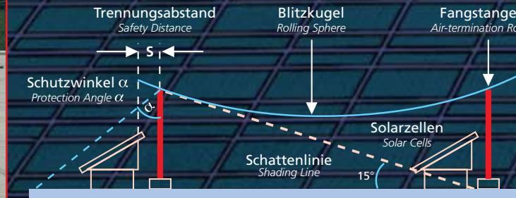
Bei Errichtung des Äußeren Blitzschutzes einer Photovoltaik-Anlage muss der erforderliche Trennungsabstand 's' zwischen Blitzschutz- und Photovoltaik-Anlage berücksichtigt werden. Die Berechnung des Trennungsabstandes erfolgt gemäß der DIN VDE V 0185-3. Die Anordnung der Fangeinrichtung darf zu keiner Beschattung der Photovoltaik-Module führen. Deshalb muss bei der Planung der Schattenwinkel berücksichtigt werden.
